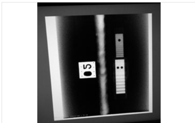
Рис. 3 — Видеоизображение на экране монитора, полученное за 1/25 секунды
