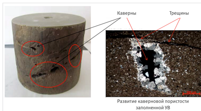
Рис. 7. Примеры каверново-трещинной структуры пустотного пространства по керну Fig. 7. Examples of cavernous-fractured structure of void space according to core
