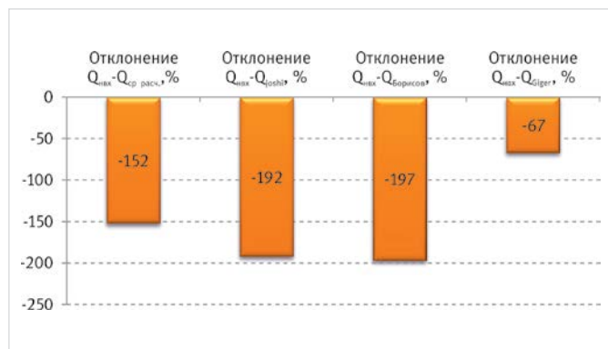
Рис. 7 — Сопоставление дебита скважины и расчетных значений дебитов по методикам S.D. Joshi, Ю.П. Борисова и G. Giger, для ГС пластов группы «А»
