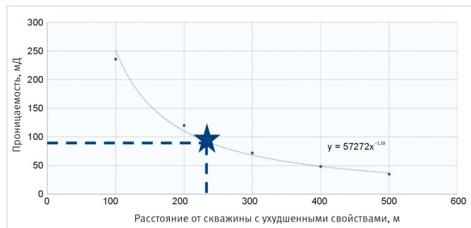
Рис. 9. График зависимости проницаемости межскважинного пространства, полученной по ГДП, от протяженности зоны с ухудшенными свойствами Fig. 9. Graph of the dependence of the permeability of the downhole space obtained by the PCT on the length of the zone with degraded properties
