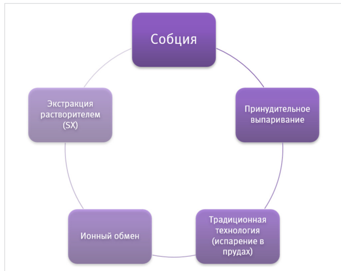
Рис. 3. Технология добычи лития из попутных вод
