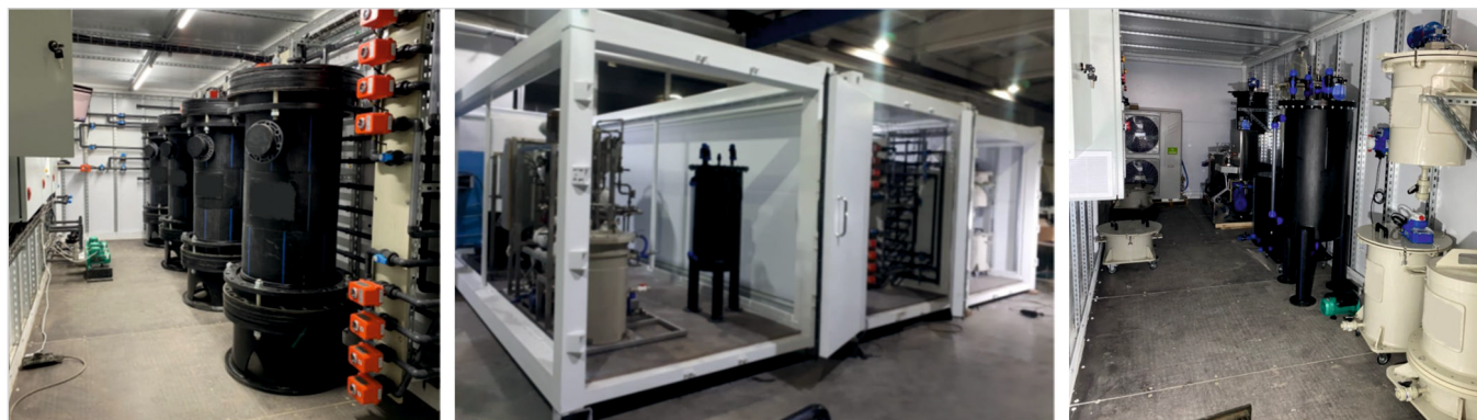
Рис. 9. Мобильный комплекс полного цикла получения карбоната лития
