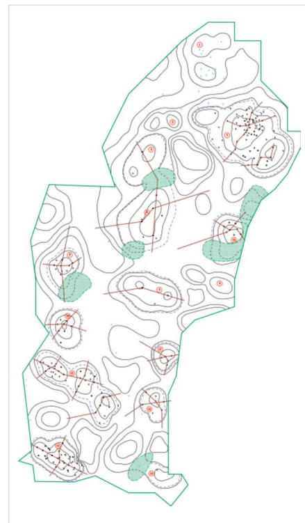
Рис. 1 — Схема размещения геологических профилей на структурной карте по кровле башкирского яруса
