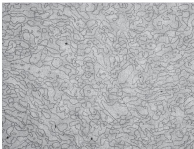
Рис. 2. Типичная микроструктура дуплексной коррозионностойкой стали SAF 2507 (светлые участки — аустенит, темные — феррит)
