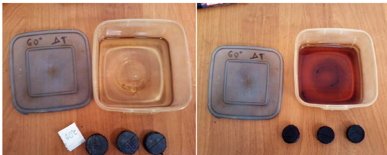
Рис. 2 — Внешний вид образцов ИРП-1226 до (слева) и после (справа) эксперимента при температуре 60°C
