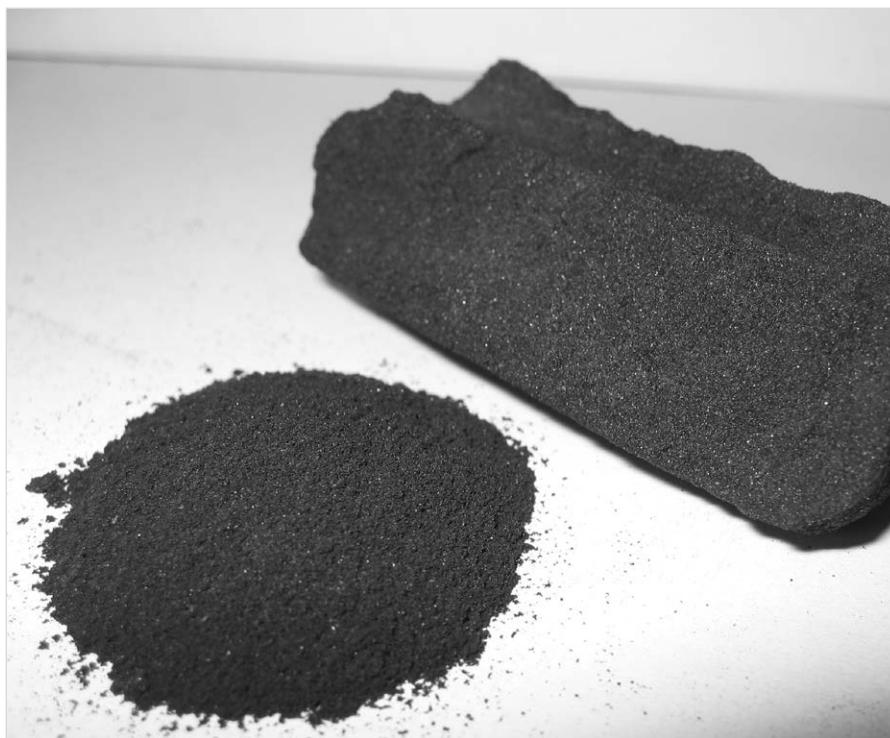
Рис. 2 — Активный сорбент, изготовлен из активированного угля
