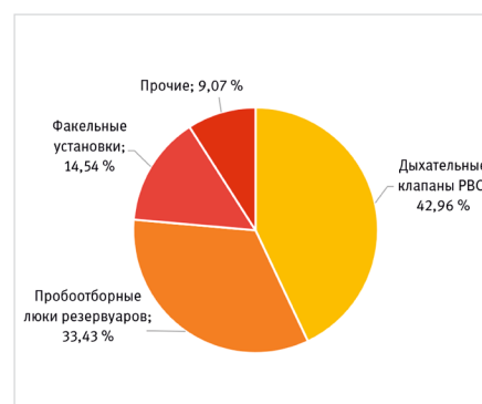
Рис. 1. Основные источники выбросов метана на объектах нефтегазодобычи в штате Техас, США (пример) [8]
