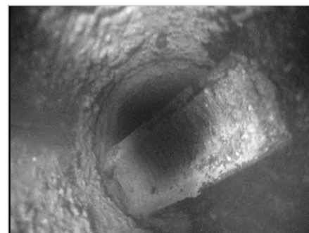
Рис. 1. Упавшая плашка застряла на стыке обсадных труб
