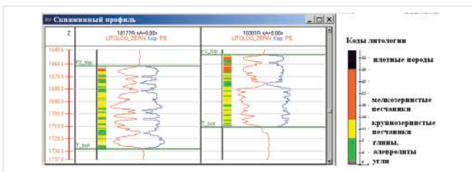
Рис. 6 — Скважинный профиль по линии 1–1 (рис. 5), характеризующий изменение литологии и пористости по фациям 1 и 2.
