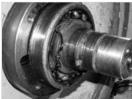
Рис. 7 Разрушение сепаратора подшипников
