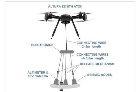
Рис. 4 — Дрон с группой сейсмоприемников, готовый к полету на профиль
