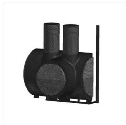
Рис. 5 — Геометрия и расчетная сетка отливки
