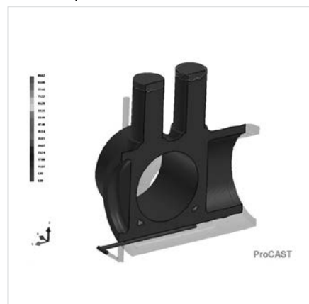
Рис. 6 — Усадочные дефекты по сечению отливки
