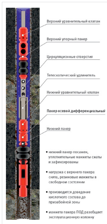
Рис. 1. Двухпакерная компоновка с телескопическим удлинителем готова для доведения кислотного состава в призабойную зону пласта при посаженном нижнем пакере
