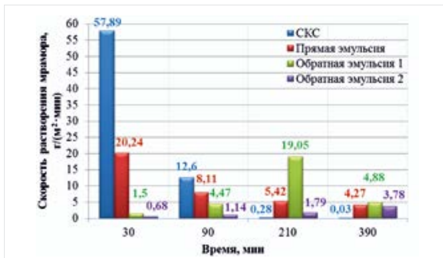
Рис. 3. Скорость растворения мраморных кубиков кислотными составами различного типа
