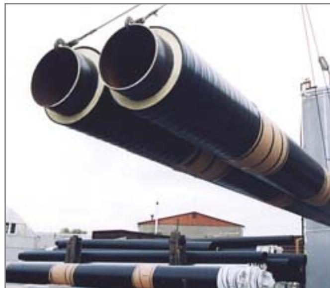
Трубы в теплогидроизоляции
