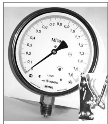
Рис.3. Вид эталонного манометра с узлом корректора нуля.
