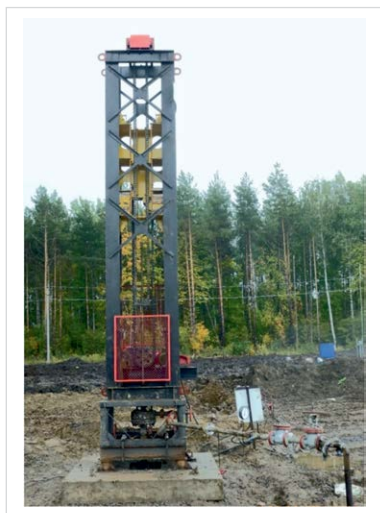
Рис. 2 — Опытный образец цепного привода ПЦ35-3,5-0,5/2,5 на скважине 4185 НГДУ «Елховнефть» Fig. 2 — Pilot PTs 35-3.5-0.5/2.5 chain drive at well #4185 of Elkhovneft Oil-and-Gas Production Division
