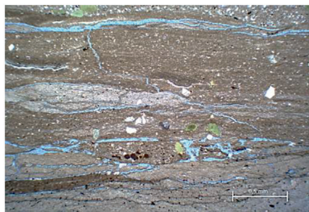
Рис. 3. Литогенетическая трещиноватость. Параллельный оси керна срез. Опоки пласта НБ 1 березовской свиты. Вид — без анализатора, увеличение 4 × Fig. 3. Lithogenetic fracturing. Cut parallel to the core axis. Fractures of formation NB 1 of the berezovskaya suite. View — without analyser, magnification 4 ×
