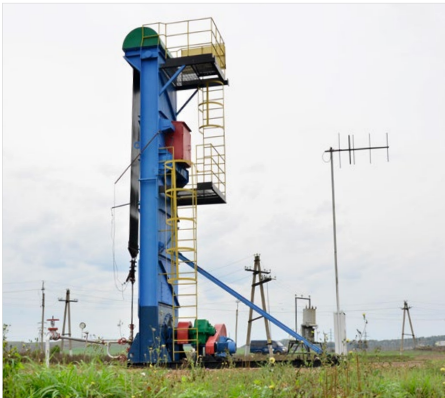
Рис. 3 — Длинноходовой цепной привод штанговых насосов
