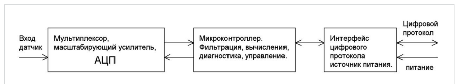
Рис. 9 — Блок-схема ПИ с выходным сигналом — цифровой протокол. Интерфейс связи не оказывает влияния на метрологические характеристики ПИ
