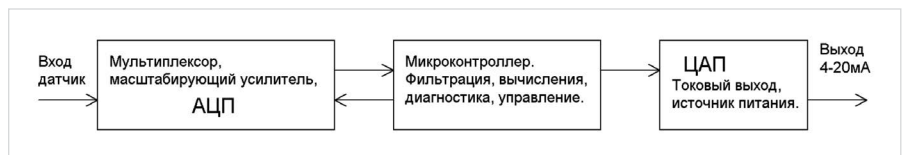
Рис. 7 — Блок-схема НП с выходным сигналом — ток 4...20мА. Характеристики ЦАП влияют на метрологические характеристики НП
