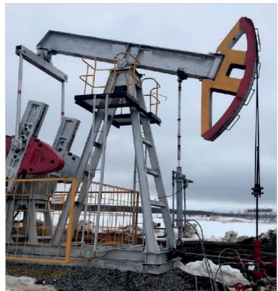
Фото 2. Компрессор скважинный, установленный на скважине
