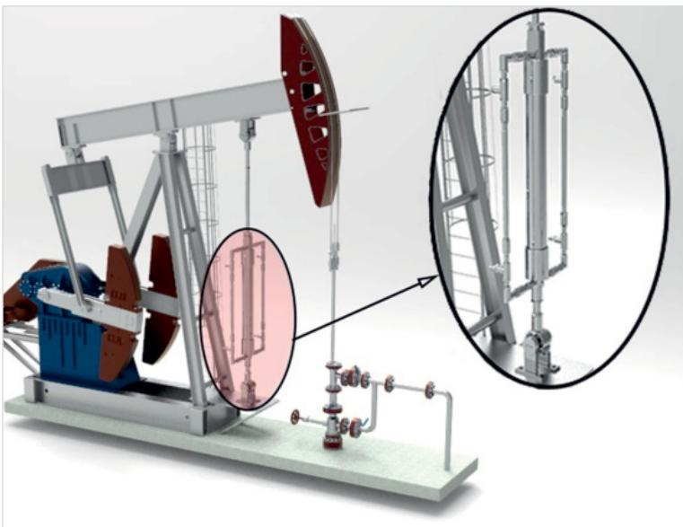
Рис. 2. Компрессор скважинный, установленный на скважине
