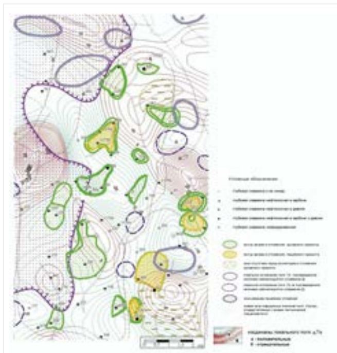
Рис. 3 — Распределение локального магнитного поля модельной площади западного склона Южно-Татарского свода Fig. 3 — Distribution of local magnetic field on the model area of the western slope of the South Tatar arch
