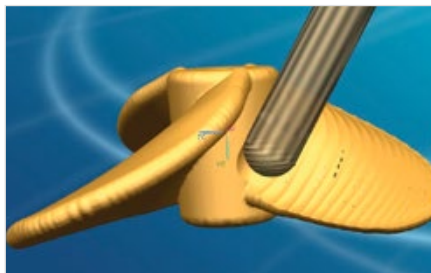
Рис. 5 — Первая модель винта, построенная и обработанная в NX 8 (2011 год)
