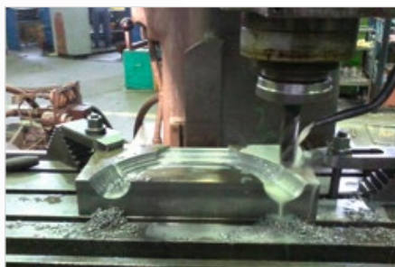
Рис. 2 — Реальная обработка на станке 6Н13Ф3 в цехе 13
