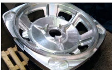
Рис. 4 — Деталь после обработки на станке HAAS EC-1600 в цехе 9
