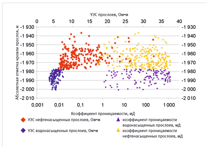
Рис. 6. Зависимость УЭС прослоев и их проницаемости от высоты (залежь пласта АС7)
