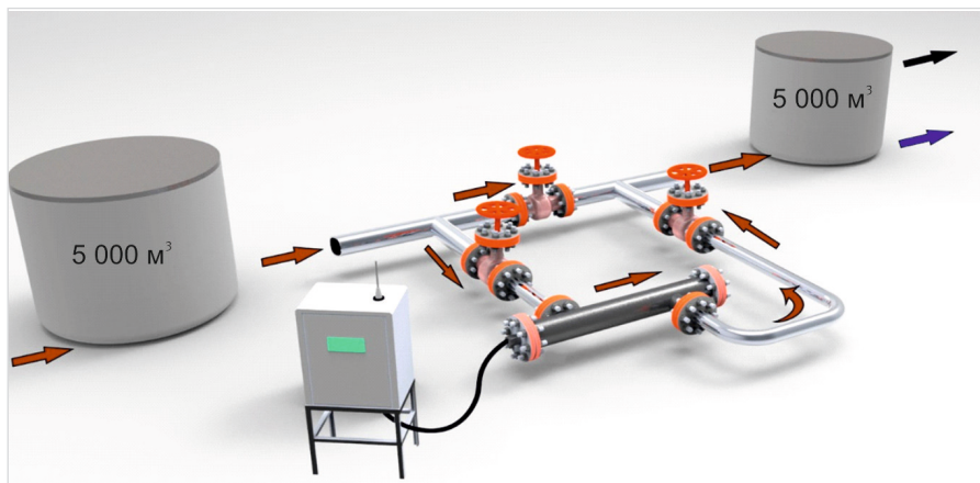
Рис. 12. Обвязка УППДС на УПСВ по байпасной схеме
