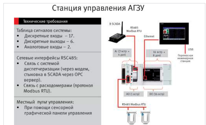
Рис. 4 — Технические требования и схема подключений к ПЛК АГЗУ
