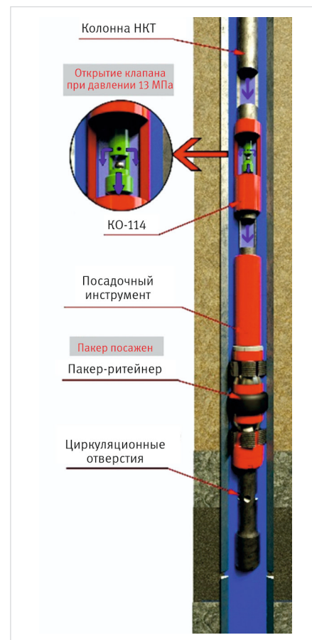
Рис. 2. Открытие клапана, посадка пакера
