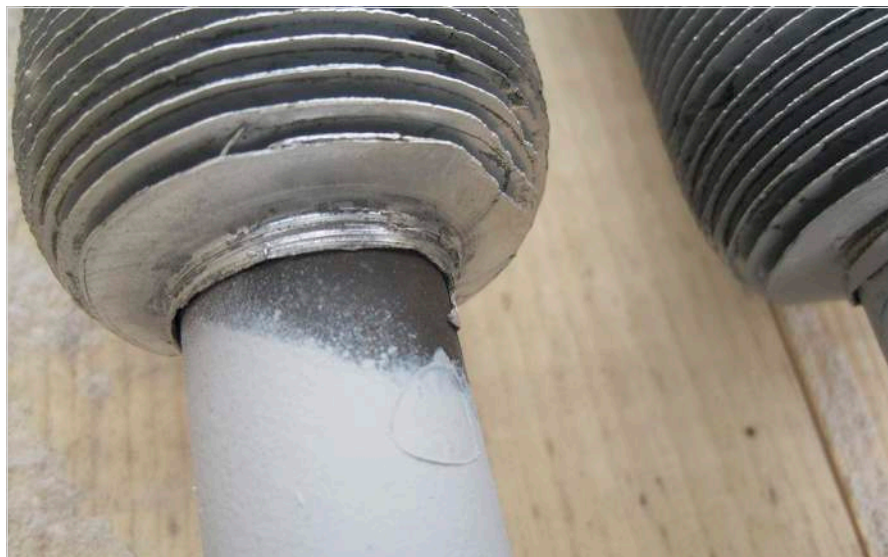
Отсутствие антикоррозионного покрытия на участках корпуса термостабилизатора
