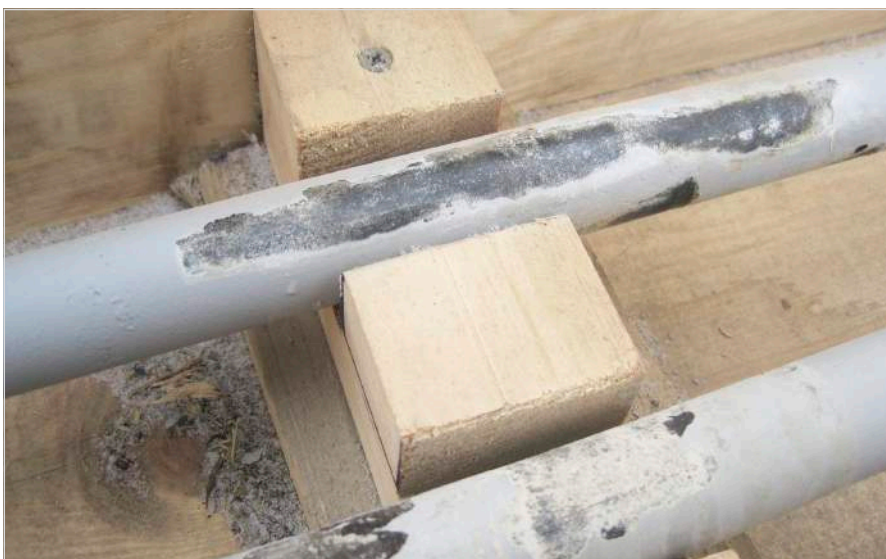
Повреждение покрытия корпуса термостабилизатора в процессе неправильной транспортировки
