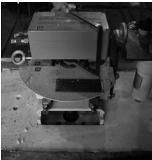
Рис. 7 — Система GBVA/DAPS после огневых испытаний
