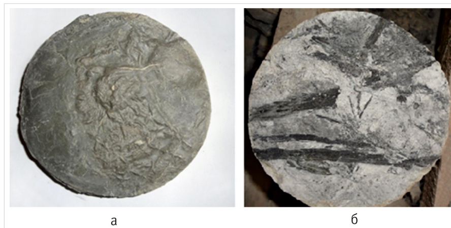
Рис. 3. Фотографии образцов керна пласта Д0. Диаметр образцов керна 71 мм: а — отпечатки и ходы червей-илоедов в глинистой пачке; б — остатки ОРО аутигенного происхождения
