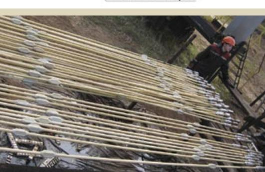
Согласно статистики отказов установок штангового глубинного насоса (далее УШГН) по узлам, доминируют отказы вызванные обрывом штанг – 18-28%, в 70% обрывов разрушения насосной штанги происходит по телу штанги.
