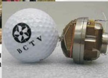
Гравиметрические измерения в скважине
