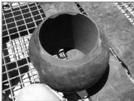
Рис.2. Износ титанового шара.
