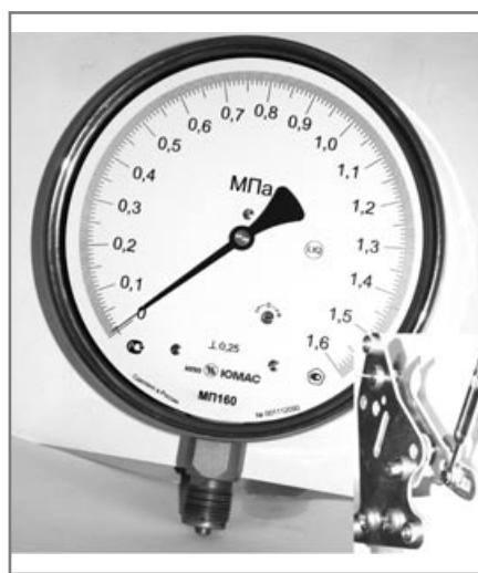
Рис.3. Вид эталонного манометра с узлом корректора нуля.
