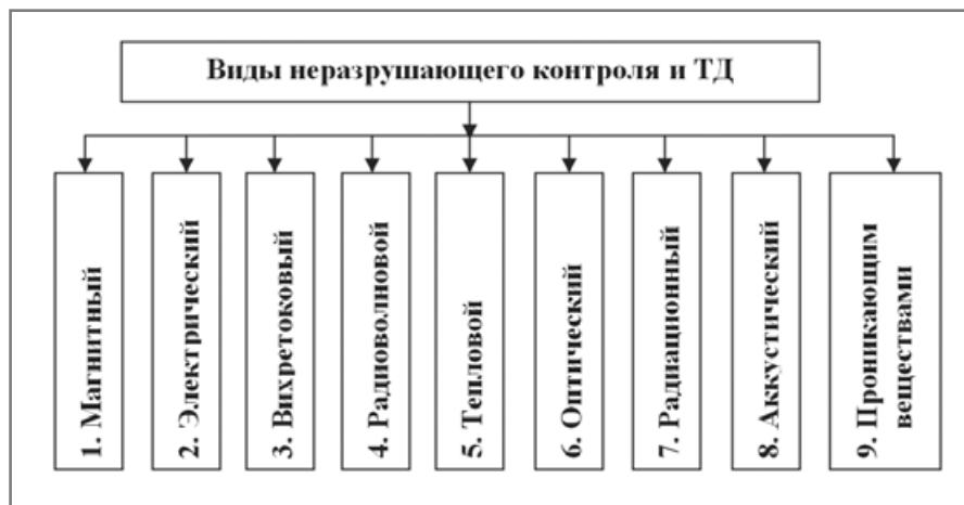
Рис. 1. Классификация видов неразрушающего контроля
