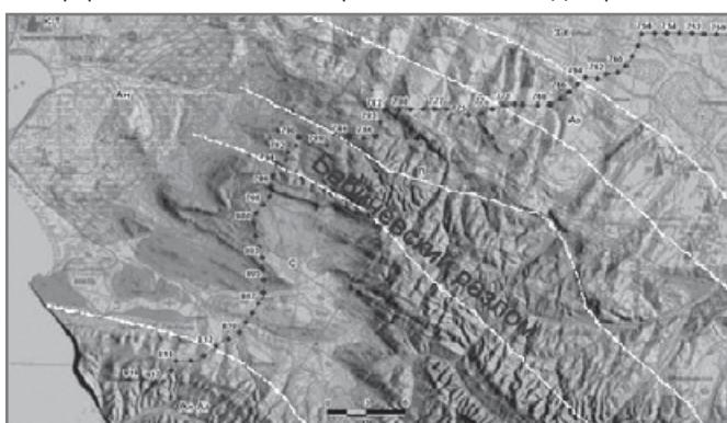
Рис.1. Тектоническая схема горного отрезка газопровода.
