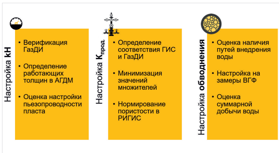
Рис. 4. Блок-схема предварительной настройки фильтрационной модели Fig. 4. Flow chart of basic history matching
