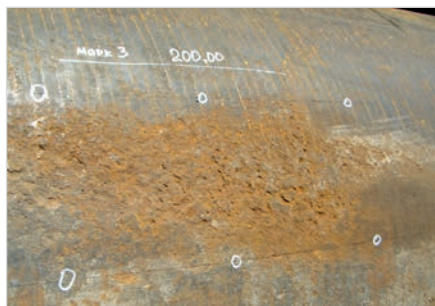
Рис. 3 — Фотографии содержащихся на плети дефектов
