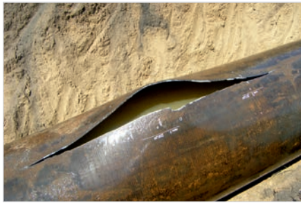
Рис. 4 — Разрушения трубной плети. а — общий вид; б — очаг разрушения Fig. 4 — Destruction of the pipework. а — general view; б — the center of destruction
