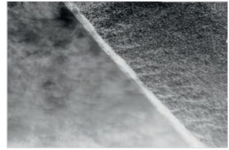
Рис. 5 — Структура металла в зоне разрушения плети (x15 000) Fig. 5 — The structure of the metal in zone of pipework destruction (x15 000)
