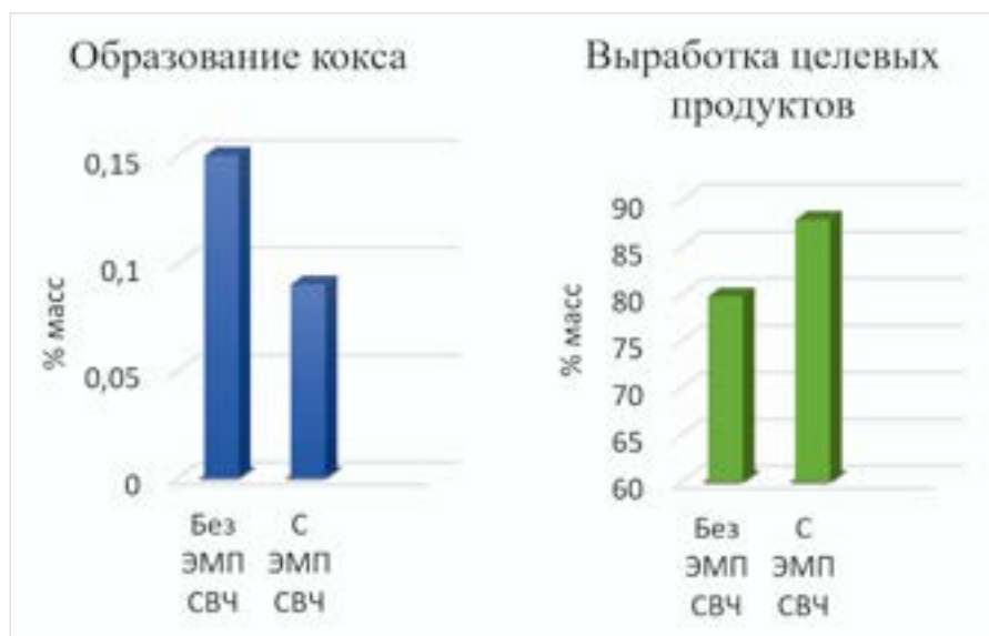
Рис. 1 – Динамика образования кокса и выработки целевых продуктов
