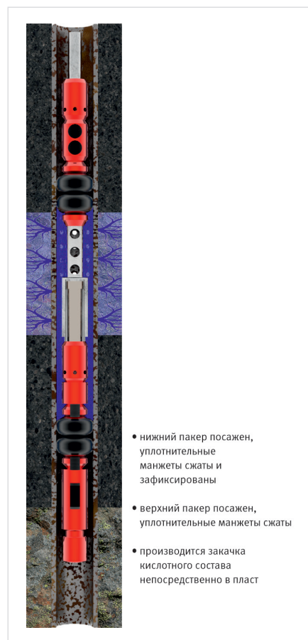
Рис. 2. Двухпакерная компоновка с телескопическим удлинителем готова для закачки кислотного состава в пласт при посаженном нижнем и верхнем пакерах
