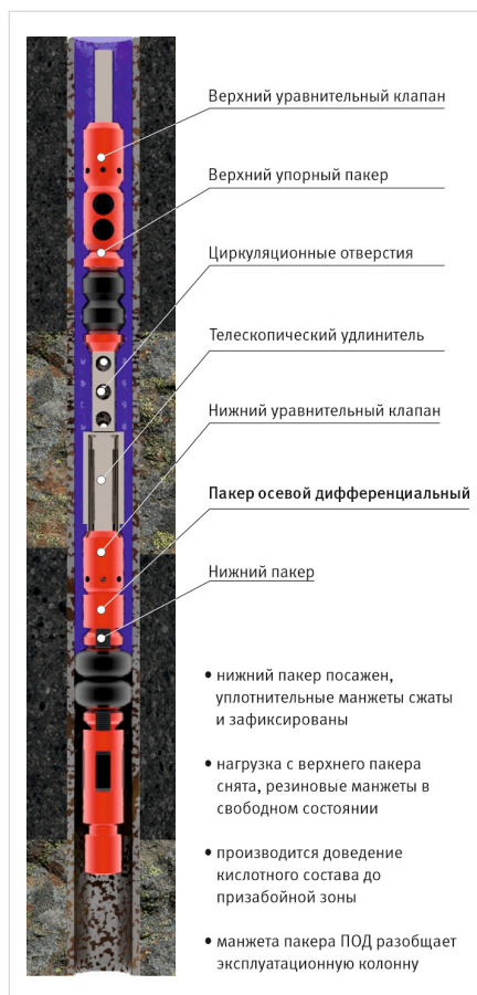
Рис. 1. Двухпакерная компоновка с телескопическим удлинителем готова для доведения кислотного состава до призабойную зону пласта при посаженном нижнем пакере
