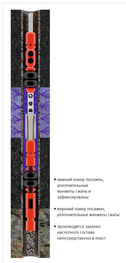
Рис. 2. Двухпакерная компоновка с телескопическим удлинителем готова для заправки кислотного состава в пласт при посаженном нижнем и верхнем пакерах
