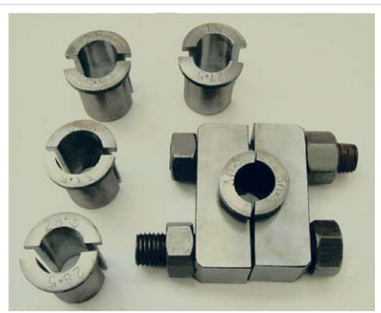
Рис. 7 — Зажим устьевого штока со вставками различных диаметров Fig. 7 — Wellhead clamp with inserts of various diameters
