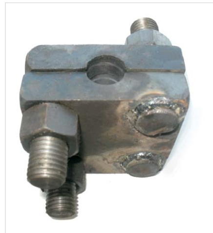
Рис. 6 — Конструкция зажима полированного штока с зубчатыми сухарями Fig. 6 — Design of polished rod clamp with toothed crackers
