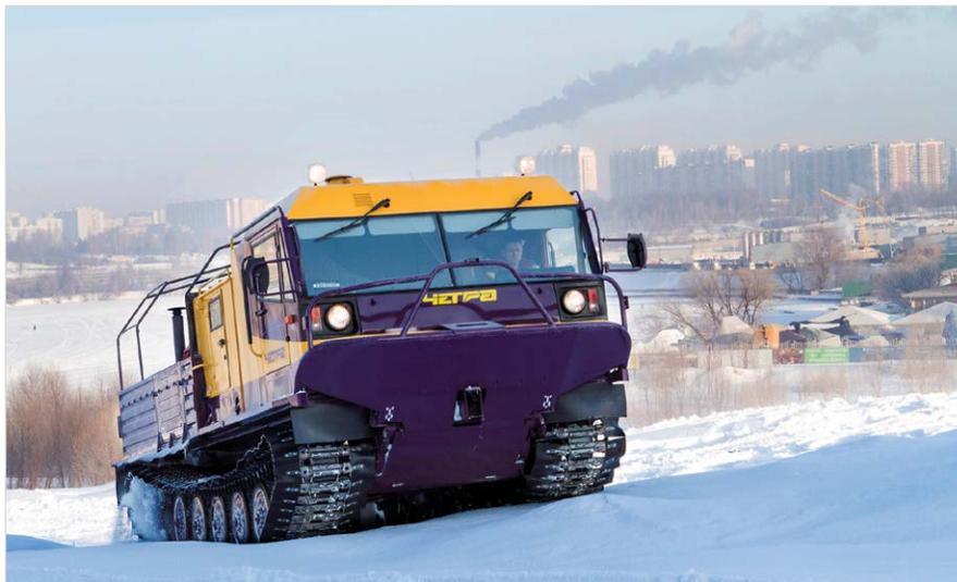
Вездеход ЧЕТРА ТМ140: грузоподъемность 4 тонны, мощность двигателя — 250 л.с.
