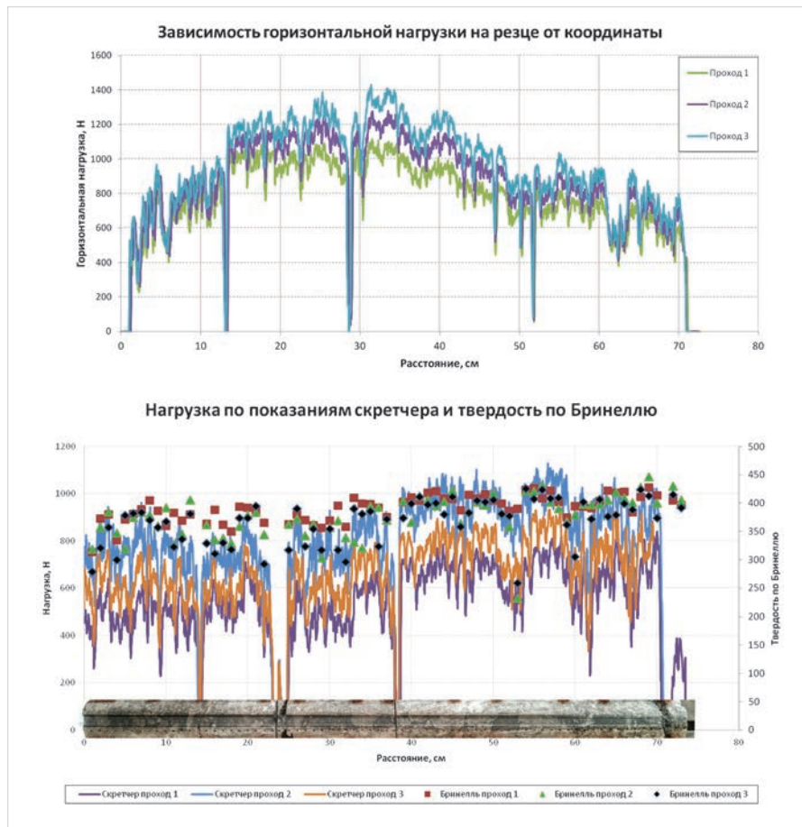
Рис. 9 — Сопоставление последовательных проходок скретч-теста и твердости по Бринеллю
