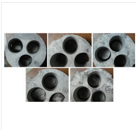
Рис. 5 — Схема выбуривания стандартных образцов керна для измерения UCS Fig. 5 — Scheme of drilling standard cores for measuring UCS
