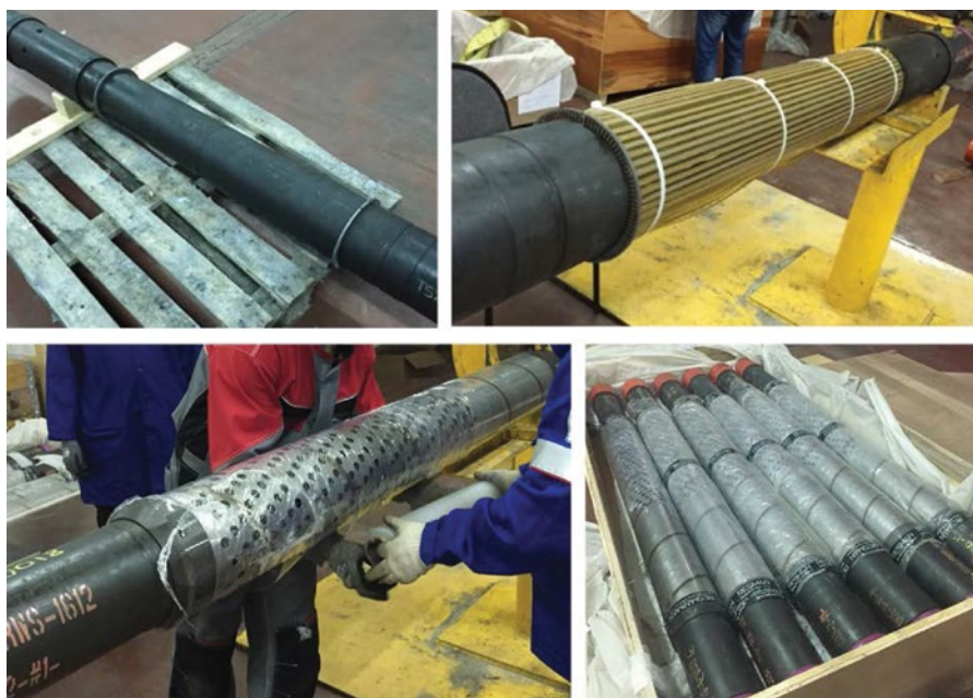
Рис. 1 — Установка полимерных матриц с интеллектуальными индикаторами притока на патрубki
