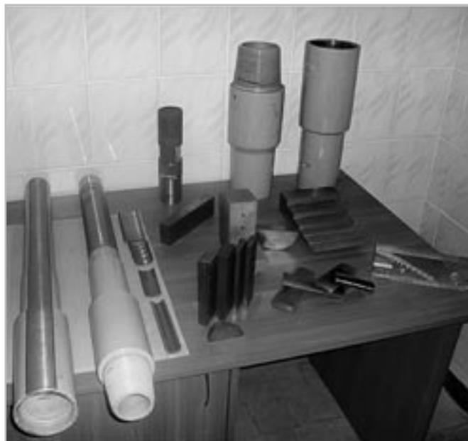
Рис. 5. Образцы с искусственными дефектами для настройки приборов при ультразвуковой дефектоскопии и толщинометрии (крупным планом показаны искусственные дефекты).
