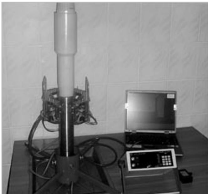
Рис. 4. Стенд для настройки приборов при ультразвуковом контроле бурильных труб и переводников (крупным планом показано устройство УМБТ-2).
