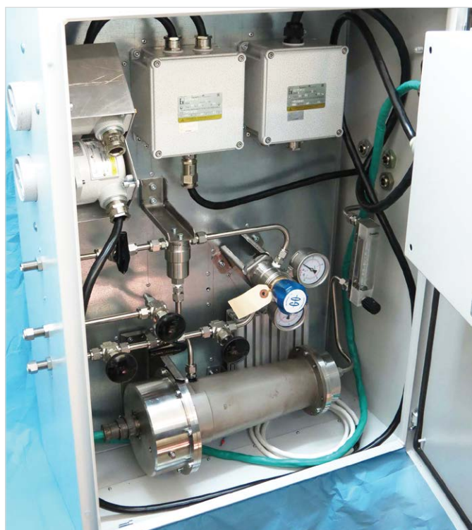
Рис. 2 — Фото внутреннего устройства гигрометра ГЛ-02
