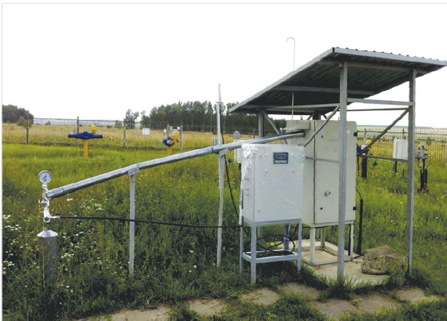
Рис. 5 — Эксплуатационные испытания лазерного гигрометра ГЛ-02
