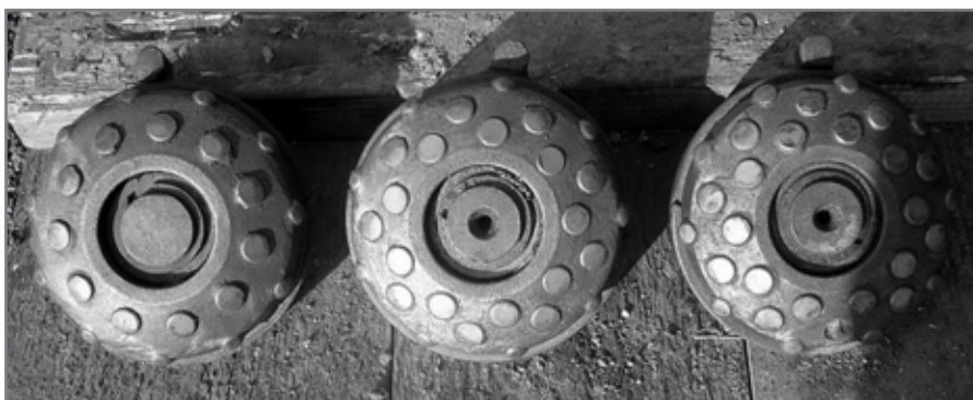
Рис. 3 – Буровые шарошки после расширения БС скважины № 207з
