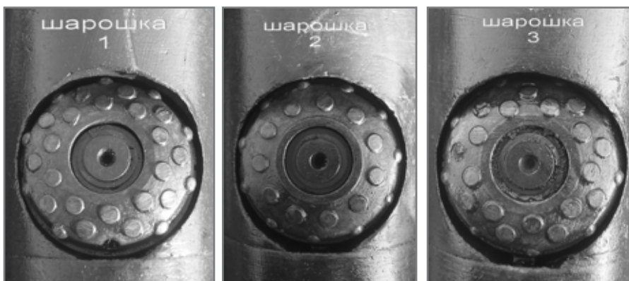
Рис. 5 – Шарошки 1, 2, 3 после расширения БС на скважине № 5912з
