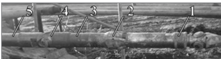
Рис. 4 – Компоновка для развальцовки профильного переключателя
