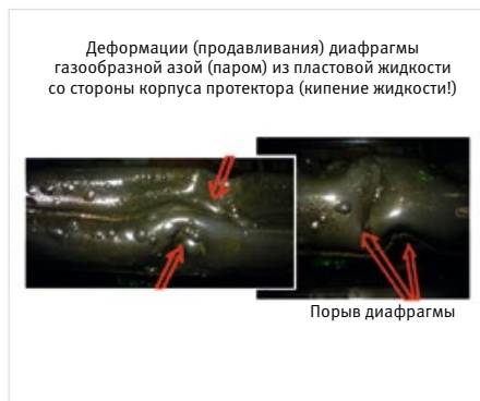
Рис. 7 — Эксплуатационные отказы эластомерных диафрагм
