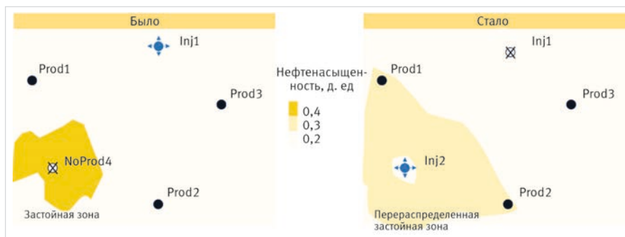
Рис. 1. Пример формирования очага заводнения: Prod1, Prod2, Prod3 — добывающие скважины, Inj1, Inj2 — нагнетательные скважины, NoProd4 — транзитная скважина Fig. 1. Example of water flooding: Prod1, Prod2, Prod3 — production wells, Inj1, Inj2 — injection wells, NoProd4 — transit well
