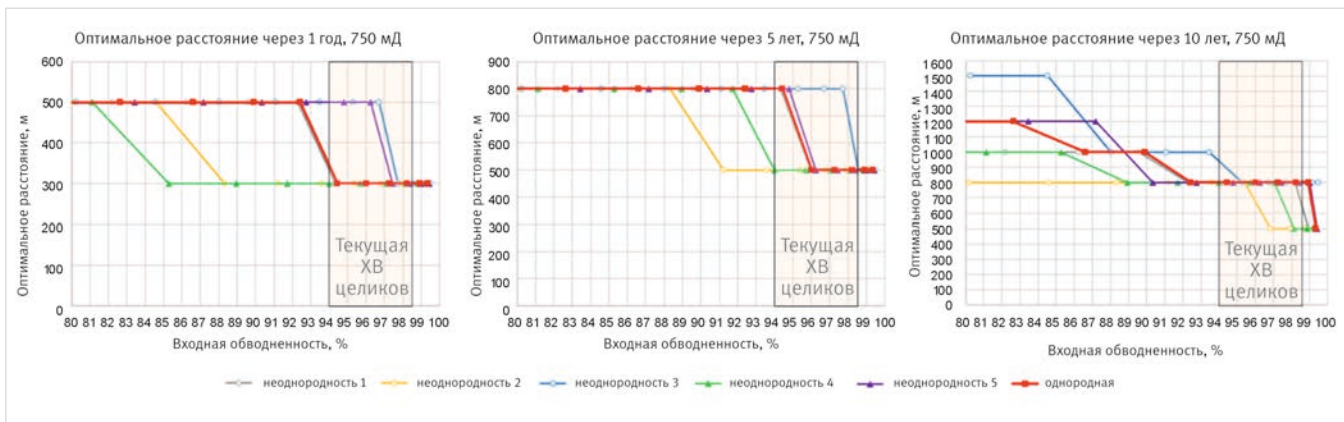
Рис. 11. Результаты по определению оптимального расстояния от ППД. 750 мД Fig. 11. Results of determining the optimal distance from the PPD. 750 mD
