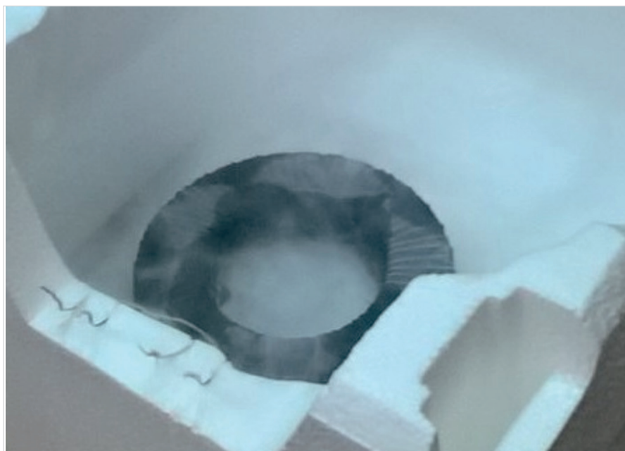
Рис. 5. Испытуемый образец трансформатора в ходе подготовки к замерам в криостате с жидким азотом Fig. 5. Test sample of the transformer in preparation for measurements in a cryostat with liquid nitrogen
