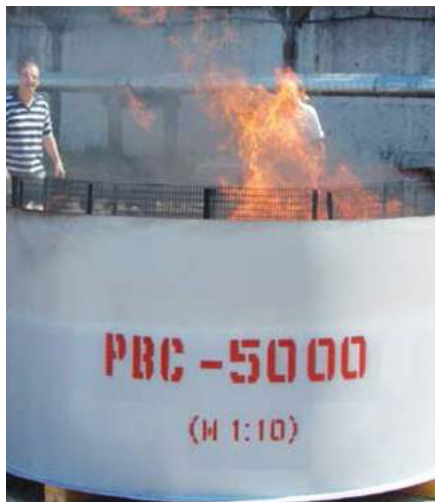
Фото 2б — Спустя 8 сек. после поджога нефтепродукта в резервуаре с пакетированным тушащим материалом
