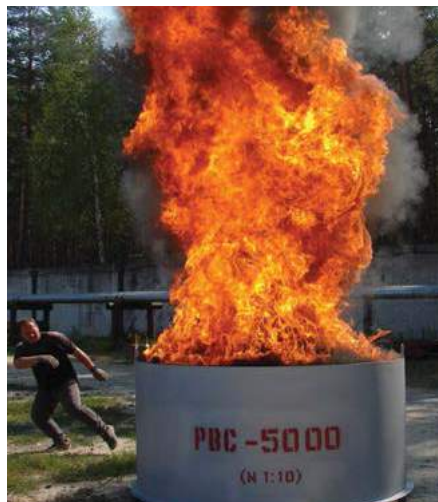
Фото 2а — Процесс горения нефтепродукта в резервуаре без применения тушащего материала (13 сек. после поджога)
