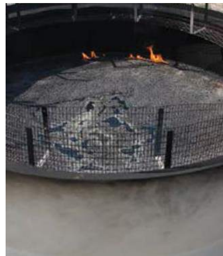
Фото 2в — Состояние поверхности через 8 минут 18 сек. после поджога
